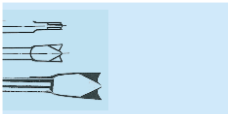
Blechtrennmeißel mit Doppelschneide Double blade panel cutter
