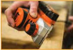
Drei V-Nuten in der Hobelsohle vergrößern die Hobeltiefe beim Anfasen von Werkstückkanten
