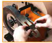
Lederabziehscheibe für rasiermesserscharf geschliffene Klingen
